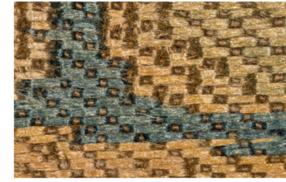
Samitgewebe mit originaler Oberfläche und voluminösen Fäden (oben) und nach einer Behandlung mit Wasser mit flachen, strähnigen Fäden
